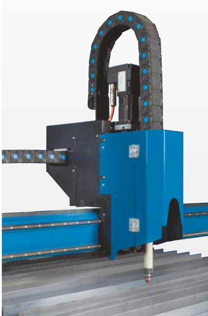
Головка для плазменной резки движется вдоль моста станка
