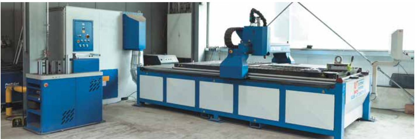
Установка плазменной резки Plasma-Jet Compact 1530 от KNUTH с источником плазмы MaxPro 200 и опцией фильтрации воздуха
