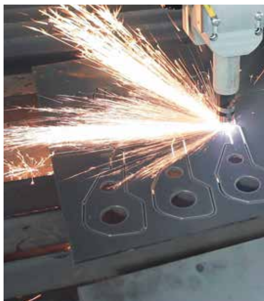
Настоящий прорыв в качестве: деталь слева была вырезана при помощи ручной плазменной системы. Деталь посередине произведена при помощи системы Plasma-Jet от KNUTH.
