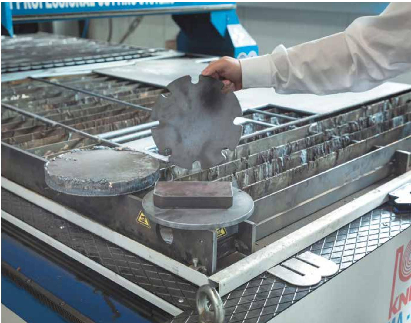
Настоящий прорыв в качестве: деталь слева была вырезана при помощи ручной плазменной системы. Деталь посередине произведена при помощи системы Plasma-Jet от KNUTH.
