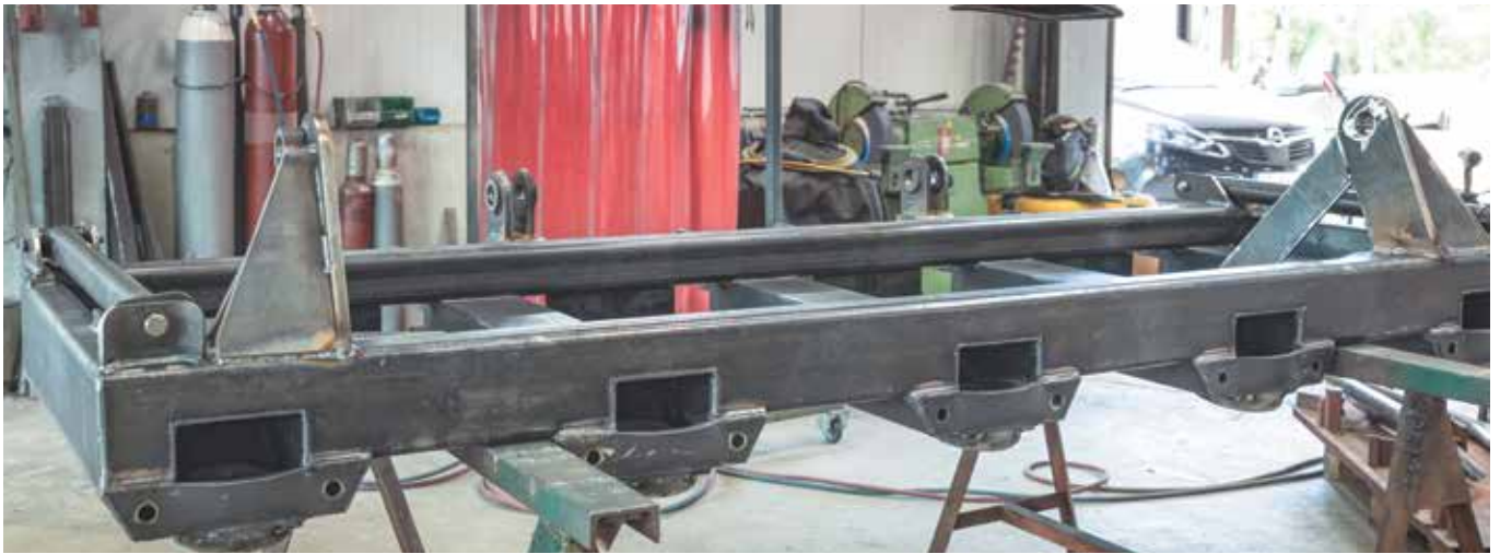
Готовая деталь, собранная из разрезанных частей, изготовленных при помощи установки плазменной резки от KNUTH
