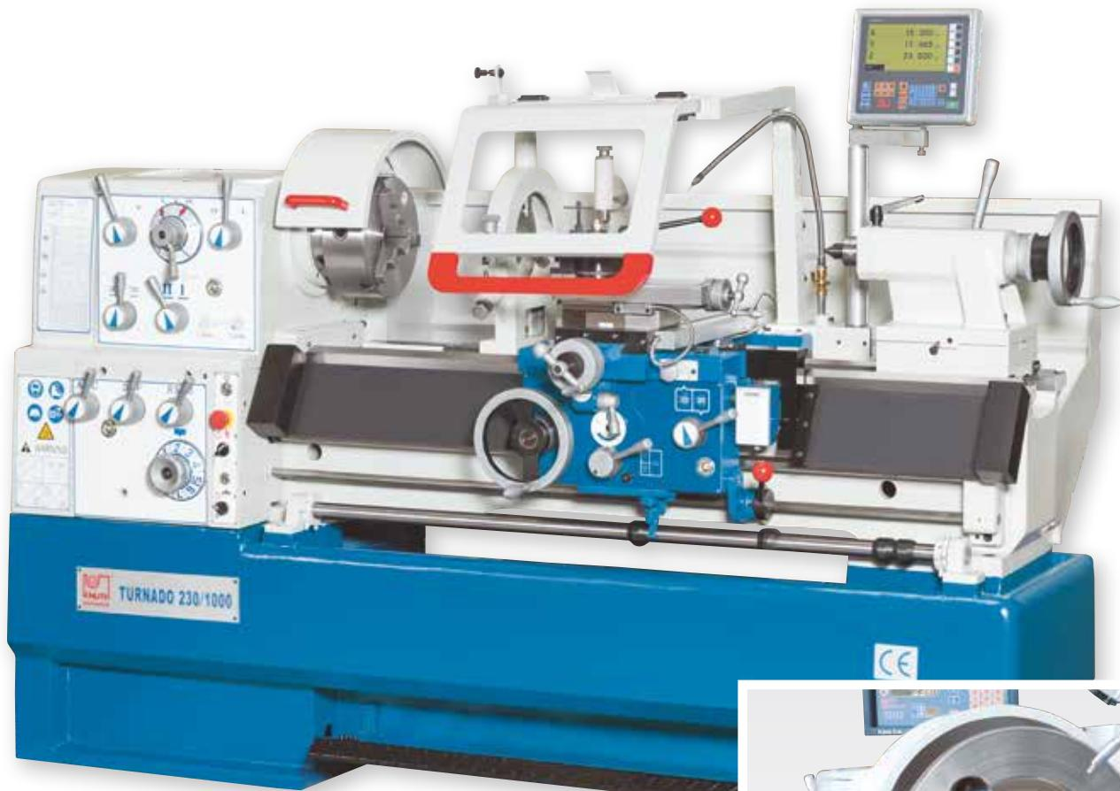
Рис.: Turnado 230/1000 с индикацией положения по 3 осям
