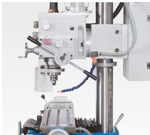
Автоматическая подача пиноли 3-ступенчатой коробкой передач
