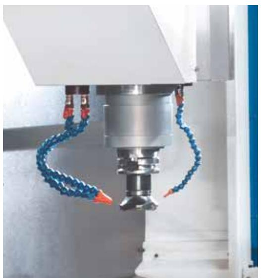
Зажим шпинделя с фрезерной головкой
