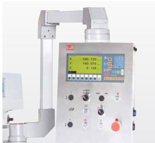
Откидная панель управления со встроенной индикацией координат - для комфортной работы
