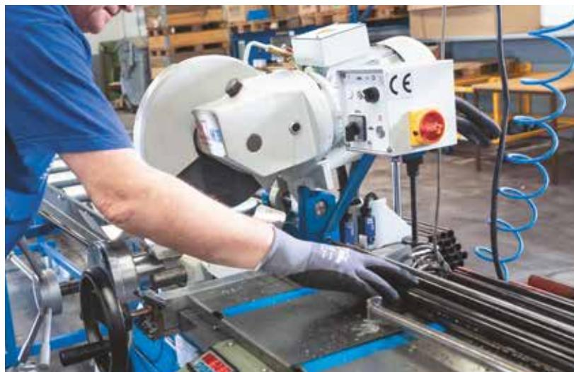
Подготовительные работы выполняются в компании Minimax полуавтоматической циркулярной пилой с пневматическим зажимом детали KHK 350 производства KNUTH. Она доводит стальные трубы до правильной длины с точностью до миллиметра.
