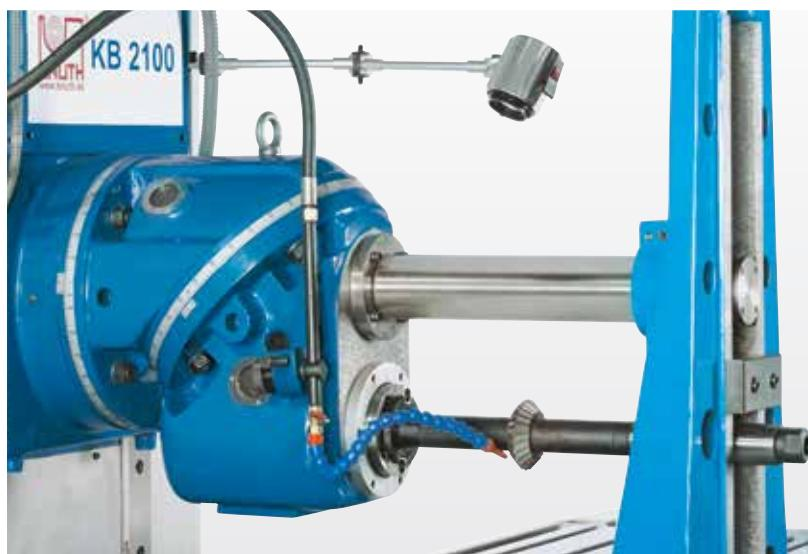
Стабильная система противодержателей для длинных фрезерных оправок
