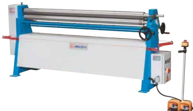
Гибочный станок для кольцевой и профильной гибки
