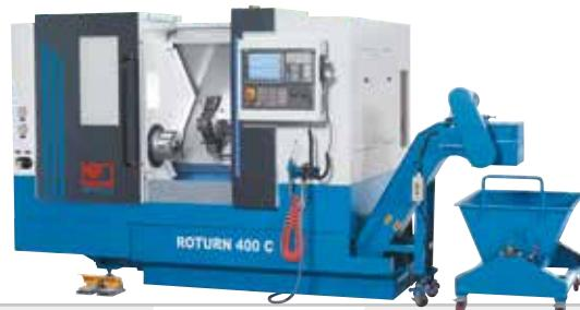
Токарный станок с наклонной станиной
