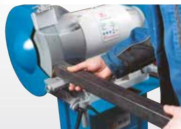
Устойчивая и широкая опора для заготовок для безопасной работы
