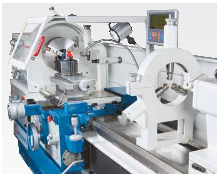
Люнеты для точной обработки длинных заготовок
