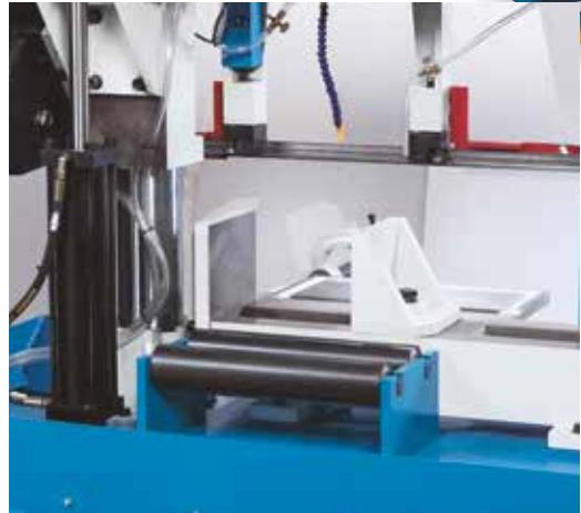
Роликовая опора для упрощения подачи материала
