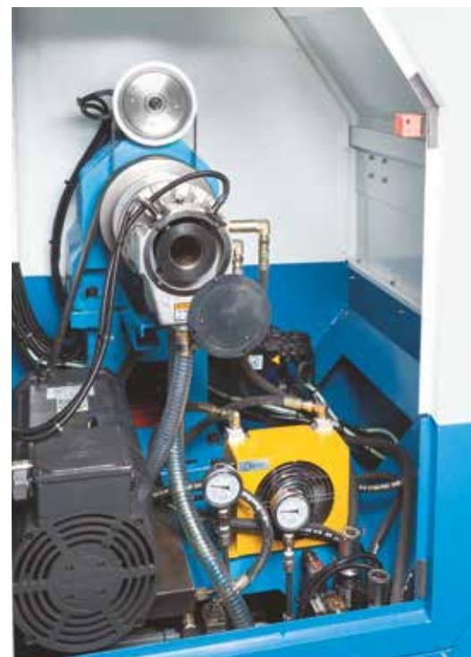
Внутренний диаметр шпинделя в трубе подачи составляет 48 мм
