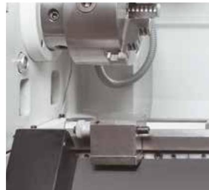
Микрометрический упор станины
