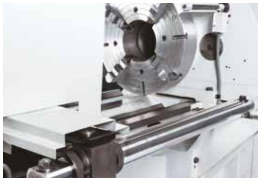
Устройство обработки конусов в серийном исполнении
