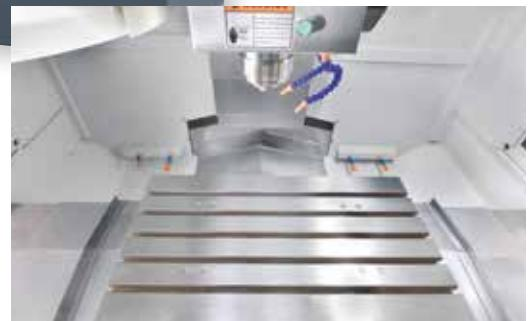
Направляющие по всем осям защищены прочными кожухами из нержавеющей стали
