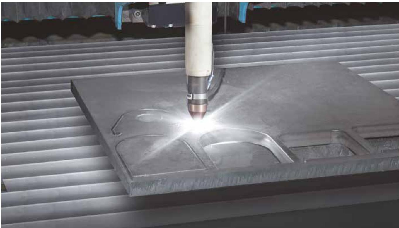
При плазменной резке электрическая дуга между электродом и заготовкой таким образом сужается с помощью режущего сопла, что делает возможным эффективную резку металлов.
