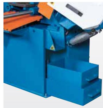
Легкодоступный бак с охлаждающей жидкостью с большим фильтром для стружки
