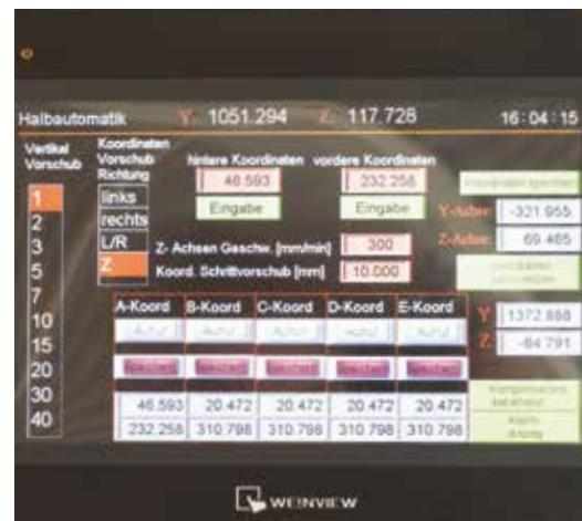
Режим правки шлифовального круга с автоматич. компенсацией измерения и регулировка частоты вращения для постоянной скорости шлифования могут быть добавлены в автоматическом режиме
