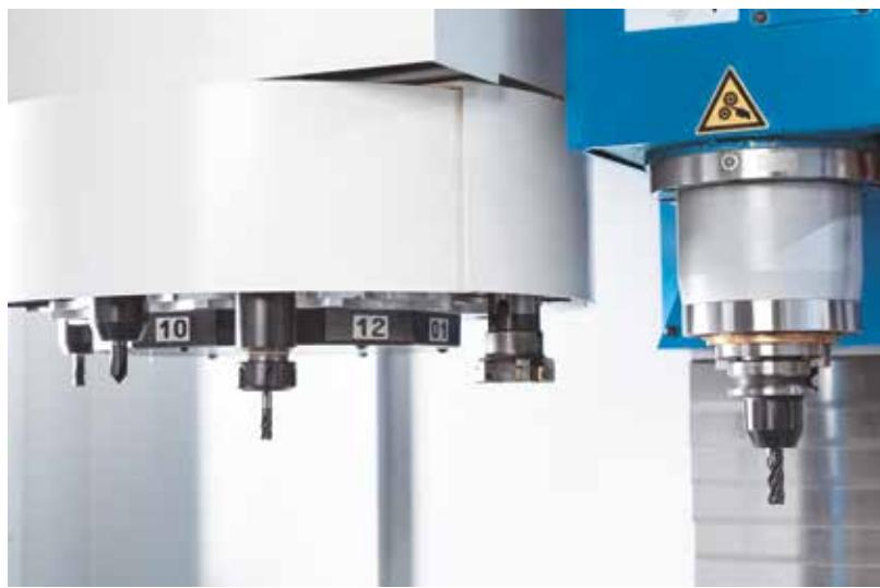
Надежное 12-позиционное горизонтальное устройство смены инструмента
