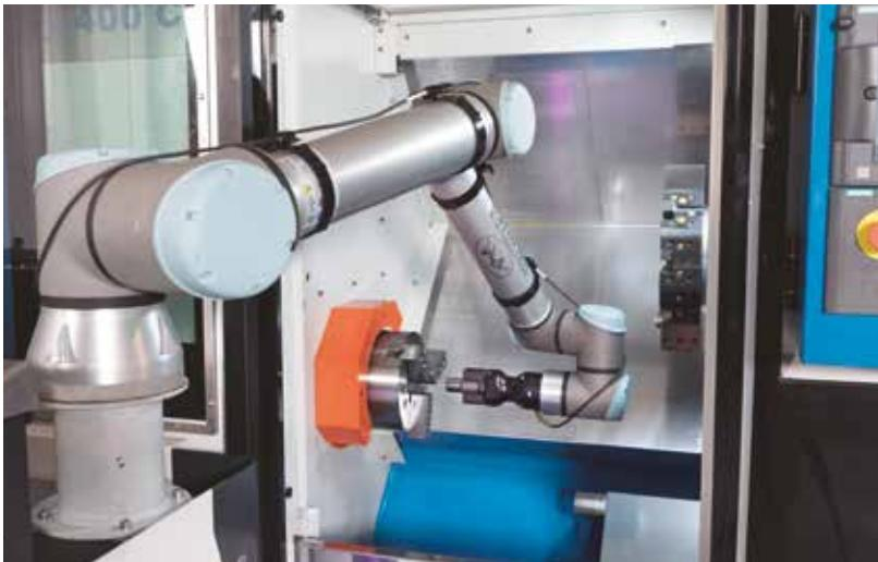
6-осевой робот-манипулятор с рабочим радиусом 1300 мм
