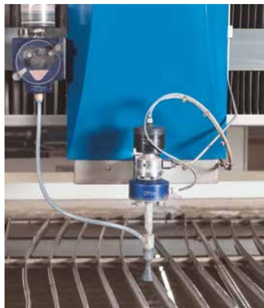
Режущая головка и абразивная система
