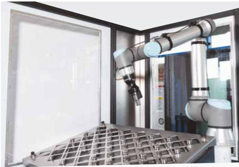
6-осевой робот-манипулятор с рабочим радиусом 1300 мм
