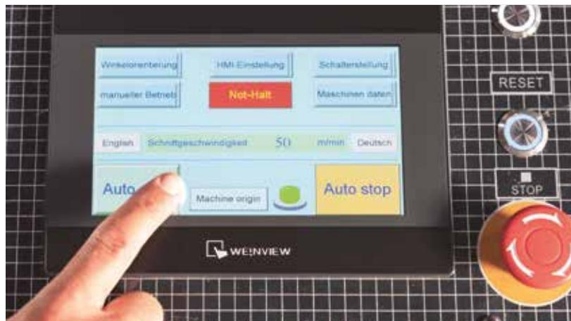
В автоматическом режиме можно программировать длину подачи, угол резки и количество резов в соответствующей конфигурации
