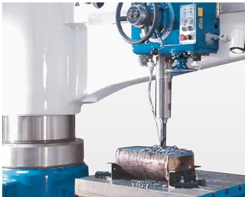
Мощная обработка в режиме автоматической подачи
