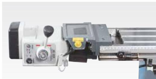
Перемещение стола фрезерного станка с бесступенчатым регулированием
