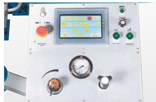
Панель управления с сенсорным экраном и графическим интерфейсом
