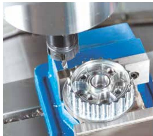
Компактный универсальный обрабатывающий центр для качественной обработки по 3-м осям
