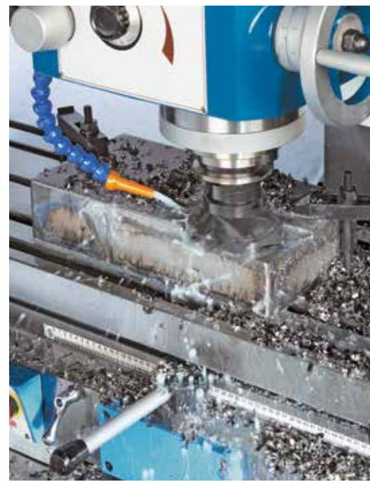
Плоское фрезерование с измерительной головкой
