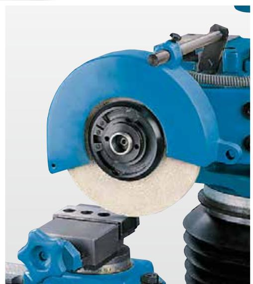
Плоское шлифование с поворотными тисками
