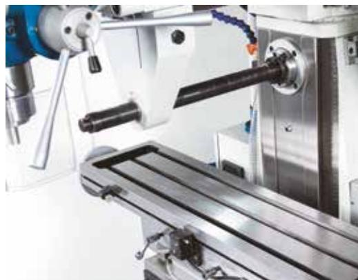
Прочная верхняя траверса с контродержателем обеспечивает надежный зажим длинных фрезерных оправок
