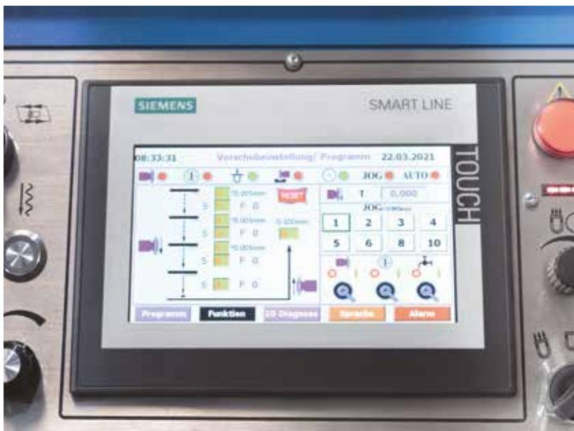
В автоматическом режиме обрабатываются определяемые оператором установки грубой и чистовой шлифовки, количество проходов и обратный ход в исходное положение
