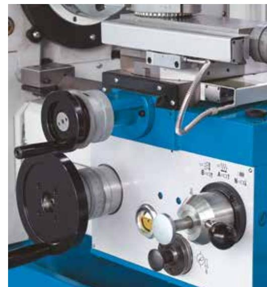
Простота технического обслуживания и эксплуатации благодаря централизованной системе подачи смазки
