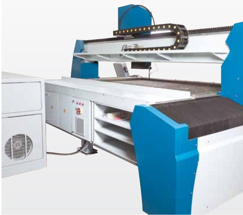
Подвижные части установки полностью защищены от попадания воды и пыли
