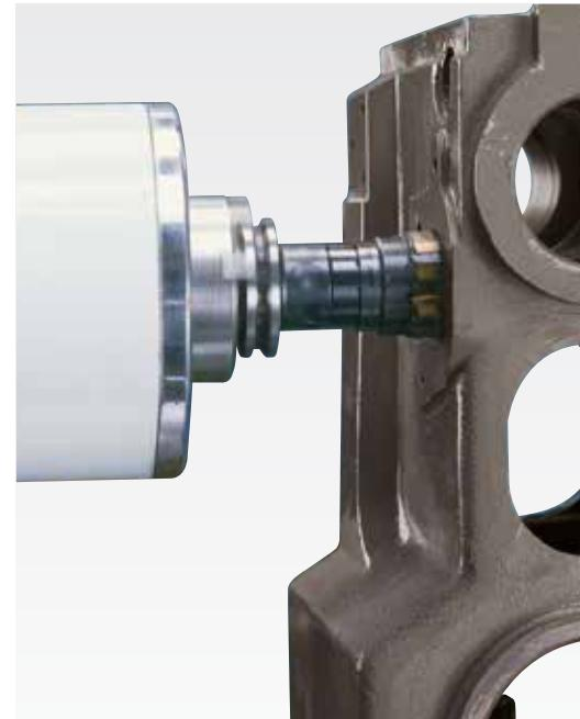
Многосторонняя обработка с помощью вращающегося стола
