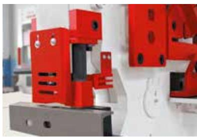
Вырубное устройство с защитным устройством
