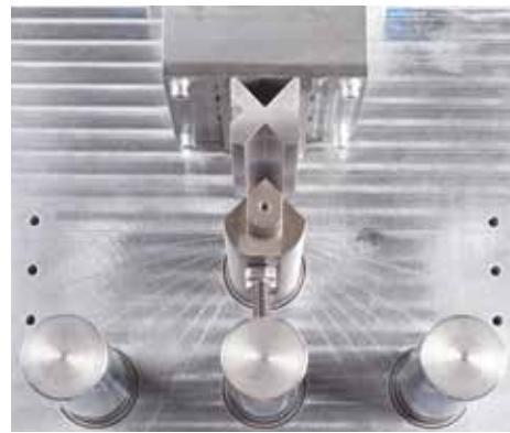
Угловые линии выгравированы на рабочем столе
