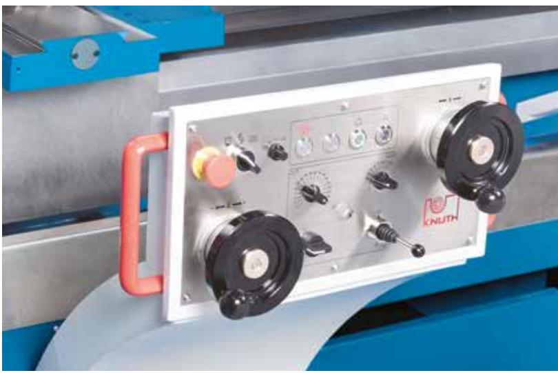
Позиционирование обеих осей может выполняться при помощи соответствующего электронного маховика
