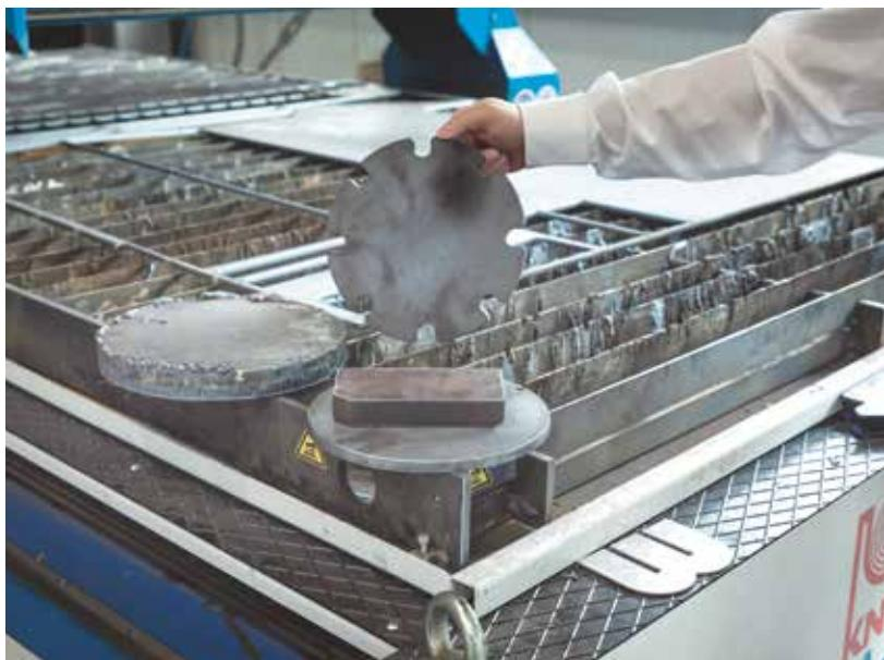
Настоящий прорыв в качестве: деталь слева была вырезана при помощи ручной плазменной системы. Деталь посередине произведена при помощи системы Plasma-Jet от KNUTH.
