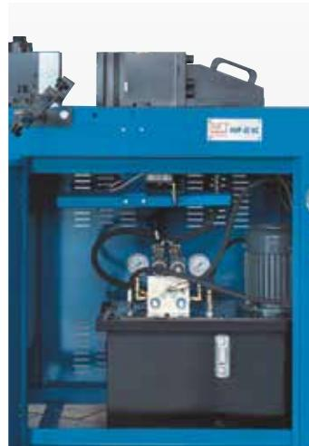
Компактный гидравлический блок
