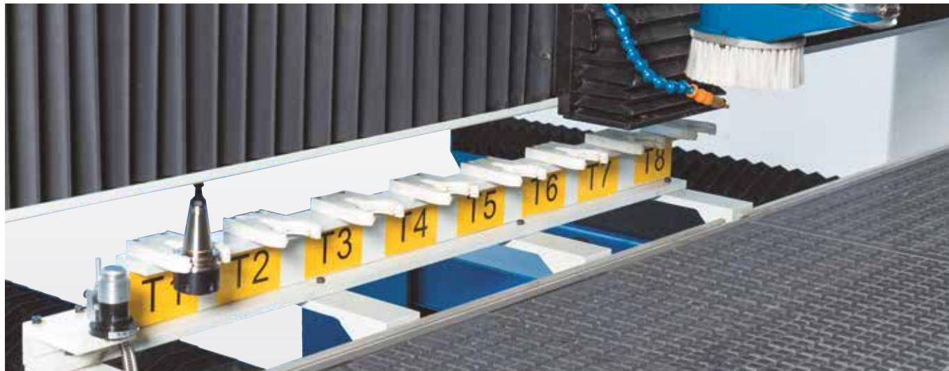
Линейный 8-позиционный узел смены инструмента
