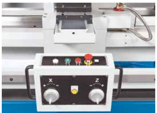
Компактный узел управления с электронными маховиками
