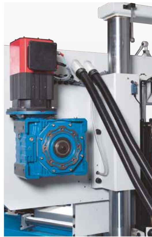
Плавная регулировка сервопривода с высоким вращательным моментом
