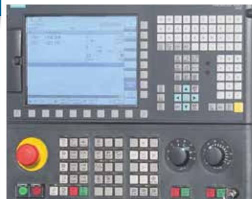
**Система управления Siemens Sinumerik 828 D Basic Drehen — компактное и простое в использовании решение для токарных станков**
