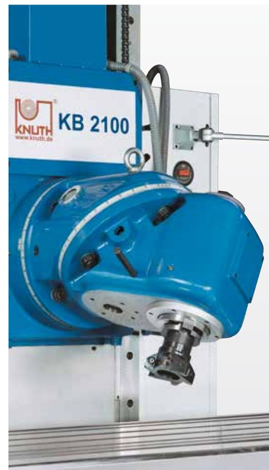
Регулировка с помощью 2-х плоскостей поворота под любым углом
