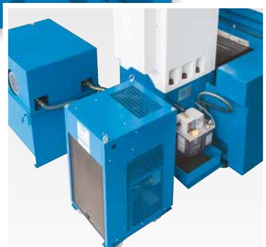
Внешний гидравлический агрегат и масляная система охлаждения позволяют сохранять стабильный температурный режим
