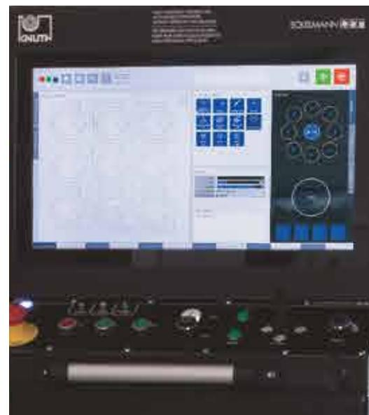
Модуль ЧПУ Eckelmann с сенсорным экраном 19" для моделей TrueCut K
