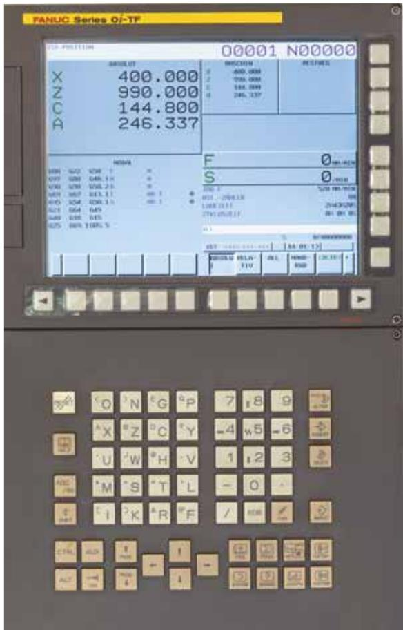
**Manual Guide:** Все созданные программы в фоновом режиме переводятся в режим DIN/ISO. Это значит, что программу, созданную в простом диалоговом интерфейсе, в любой момент можно открыть для редактирования в режиме DIN/ISO, и наоборот. Можно загружать и обрабатывать сторонние программы DIN/ISO, а программы, созданные в Manual Guide i, можно передавать на другие станки, обеспечивая таким образом оптимальную совместимость.
