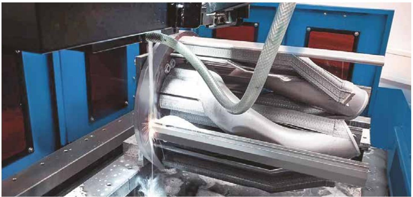
В процессе аддитивного производства сложные компоненты создаются на металлической пластине, которая затем отделяется (Neospark 500 B, Continental Engineering Services)
