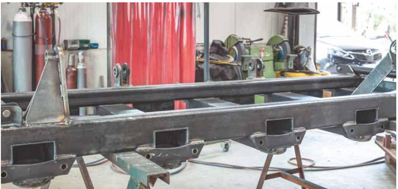
Готовая деталь, собранная из разрезанных частей, изготовленных при помощи системы Plasma-Jet от KNUTH
