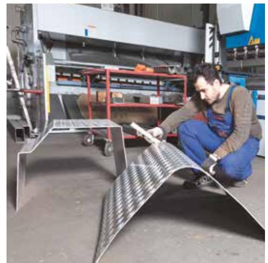
Почти завершенный компонент с радиусом и защитным покрытием для топливного бака длинного грузовика
