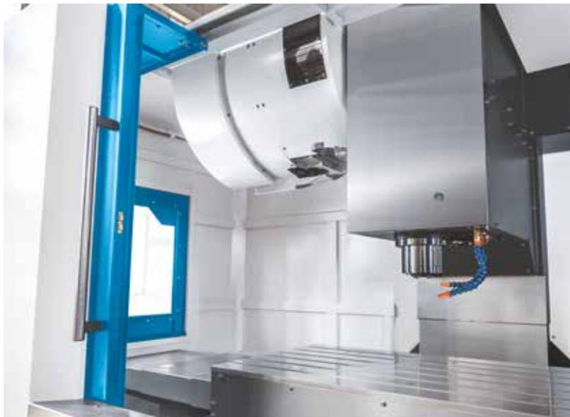
Полностью закрытое рабочее пространство с большими дверными и боковыми проемами обеспечивает легкий доступ, безопасность и чистоту
