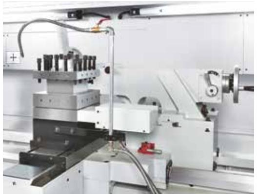
Простое управление: для позиционирования заднюю бабку можно соединить с суппортом
