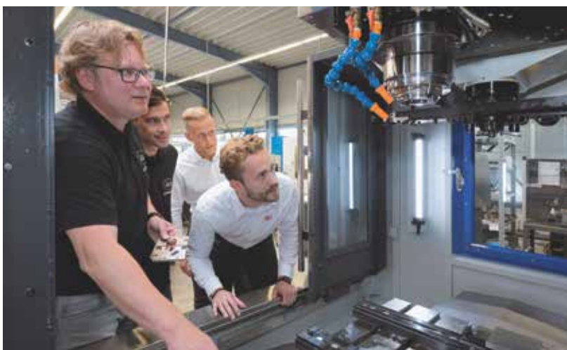
Оптимизированный механизм смены инструмента и оптимизированное охлаждение через шпиндель значительно улучшают функциональность станка
