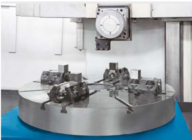
Зажимная шайба с 4-позиционным инструментальным магазином
