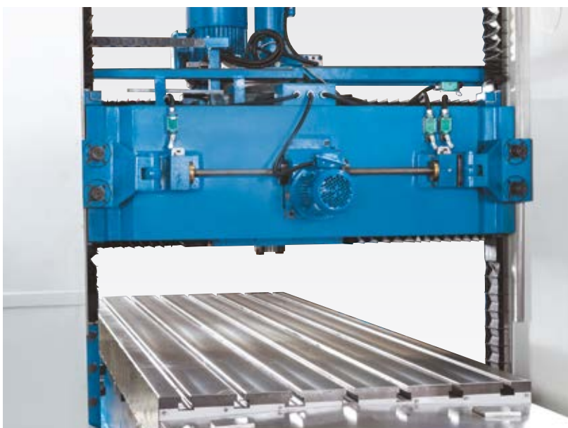
Очень мощный зажим траверсы фиксирует их позицию
